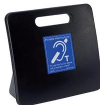
Estos audífonos tienen una bobina que transforma ese campo magnético nuevamente en sonido dentro de la oreja del usuario, aislado de reverberaciones y ruido ambiente. El resultado es que el usuario recibe un sonido limpio, nítido, perfectamente inteligible y con un volumen adecuado.
